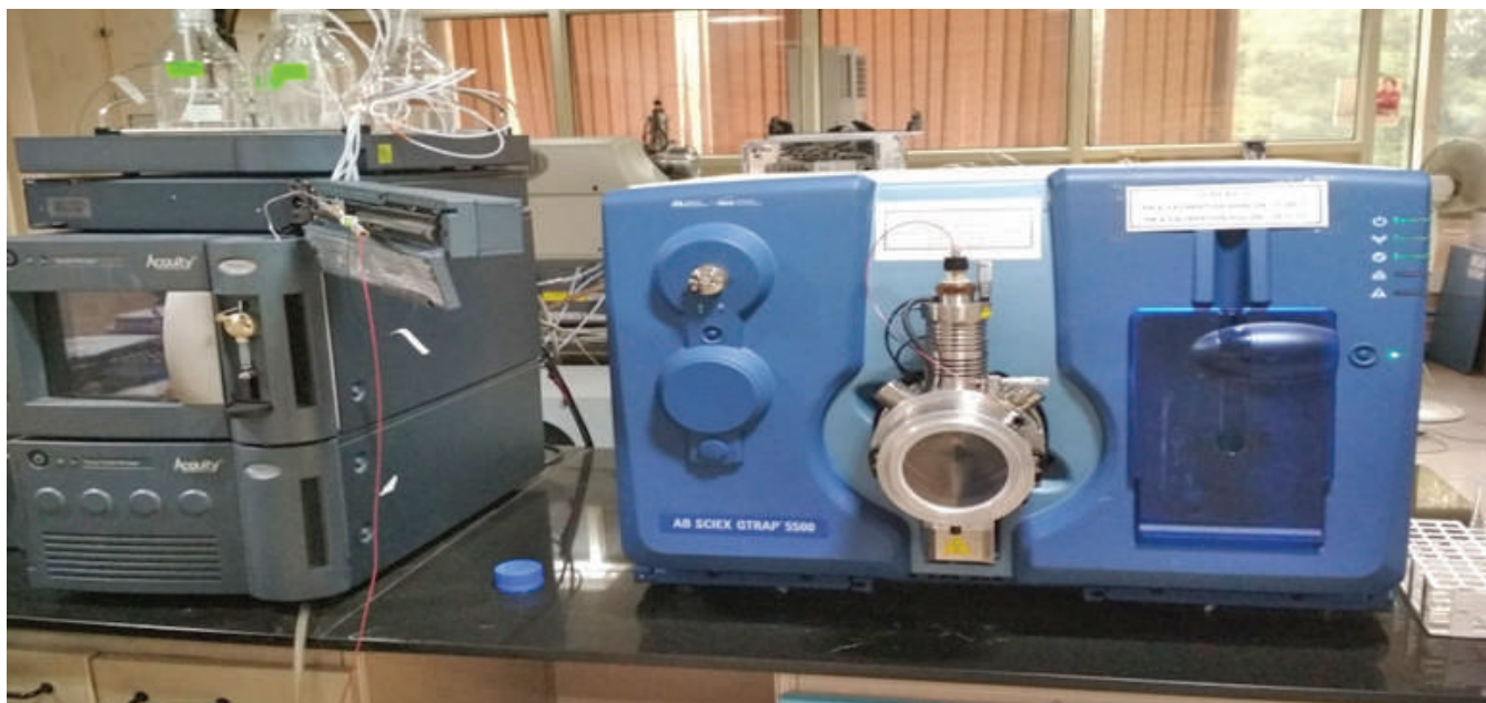
तरल क्रोमैटोग्राफी – मास स्पेक्ट्रोमेट्री (एलसी-एमएस/एमएस उपकरण)
